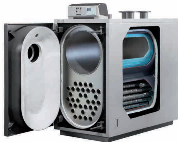
Sezione tubi fumo con turbolatori inseriti
